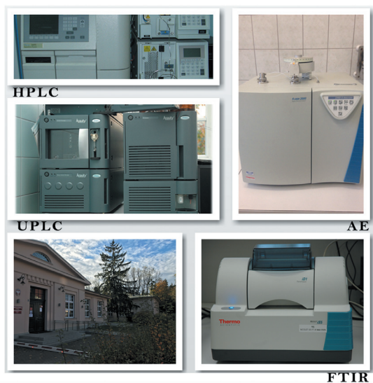
Budynek Katedry Chemii i wybrana aparatura analityczna: chromatografy, spektrofotometr i analizator elementarny, które umożliwiają wykonanie analizy związków organicznych, badanie struktury chemicznej i składu pierwiastkowego m.in. węgla, wodoru, tlenu i azotu
