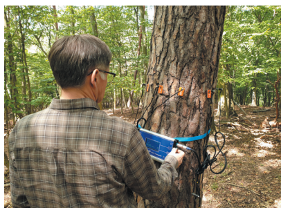
Próby tomografii dźwiękowej (PICUS) do badania zgnilizny wewnątrz pni drzew
