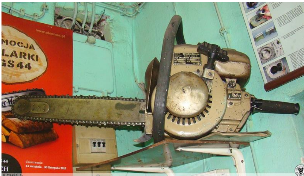
Ryc. 5. Jeden z pierwszych modeli pilarek jednoosobowych wyprodukowany przez firmę Stihl w 1952 roku (www.stihl.com)
